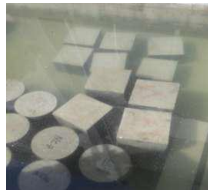
Fig No:4.2 Curing tank
