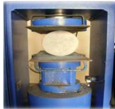
Fig No:4.1 Split tensile test
